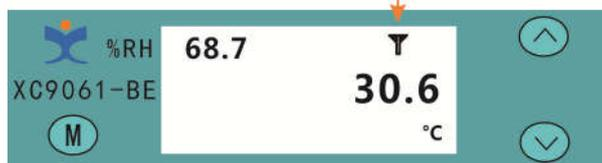
3. 设备进入工作状态，设备立即将读取到的温湿度值发送到无线传感器网络的网关，然后进入休眠状态，当数据采集周期到时，设备就从休眠态转入工作态，采集温湿度并发送给网关，如此周而复始的运行；数据采集周期时间可用户设置。
