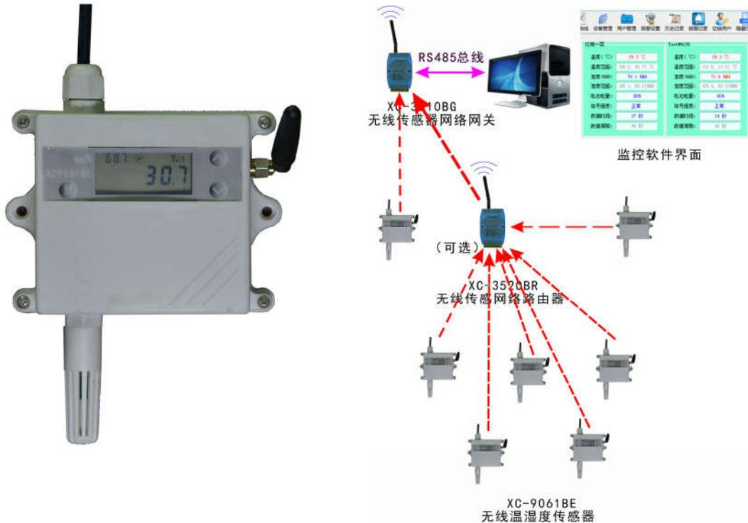
XC9061BE 无线温湿度传感器，自带 ChipBeeNet 自组网协议，是集传感器、I/O、低功耗、无线通信技术于一体的无线智能传感器产品。XC9061BE 无线温湿度传感器与无线路由器（XC-3520BR）、无线 Modbus RTU 网关（XC-3510BG）一起组成无线温湿度传感器网络，XC9061BE 传感器将采集到的温湿度数据通过无线路由器或直接发送到无线网关，电脑等上位机通过无线网关获得终端温湿度数据。采用低功耗技术，XC9061BE 无线温湿度传感器可以用 2 节 5 号电池供电正常工作一年(5 分钟数据发送间隔)。产品工作于 ISM 频段，具有体积小、功耗低、免安装、抗干扰能力强、通讯距离远、组网灵活、性能可靠稳定、使用方便等优点。
