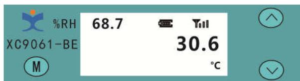
4. 设备进入休眠态，LCD 显示如下图，为了省电，用户可以设置休眠时关闭液晶显示。
